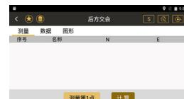
②选择“测量”选项，进行第一个控制点的输入和测量工作。在点名一栏输入控制点点名，镜高一栏输入棱镜高度，然后对准棱镜选择“测角 & 测距”，然后点击“完成”。
