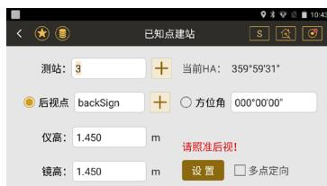
②设置测站点，通过[+] 调用或新建一个已知点作为测站点。输入镜高和仪高。
