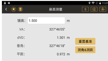
② 输入镜高后照准棱镜，点击“测角 & 测距”，得出高、垂角和平距的信息。
