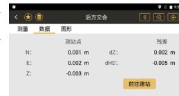
④点击“前往建站”，输入测站名并照准最后一个测量点，点击“设置”则建站完成。
